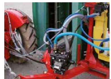
Knick- und hydraulische Lenkdeichsel (für enge Vorgewende)
